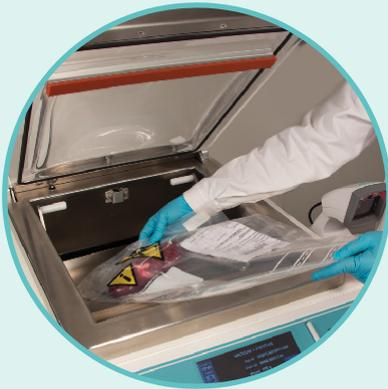
Ubique la muestra en la bolsa de vacío e introdúzcala en la cavidad. Cierre la tapa.
